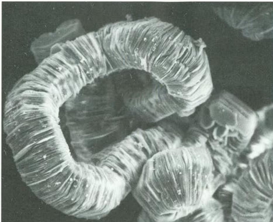
Abb. 19: Chloritaggregat (Chamosit) (Bildbreite ca. 0,3 mm). Fundpunkt wie Abb. 18. REM-Aufnahme: Dr. B. Ullrich, Freiberg
